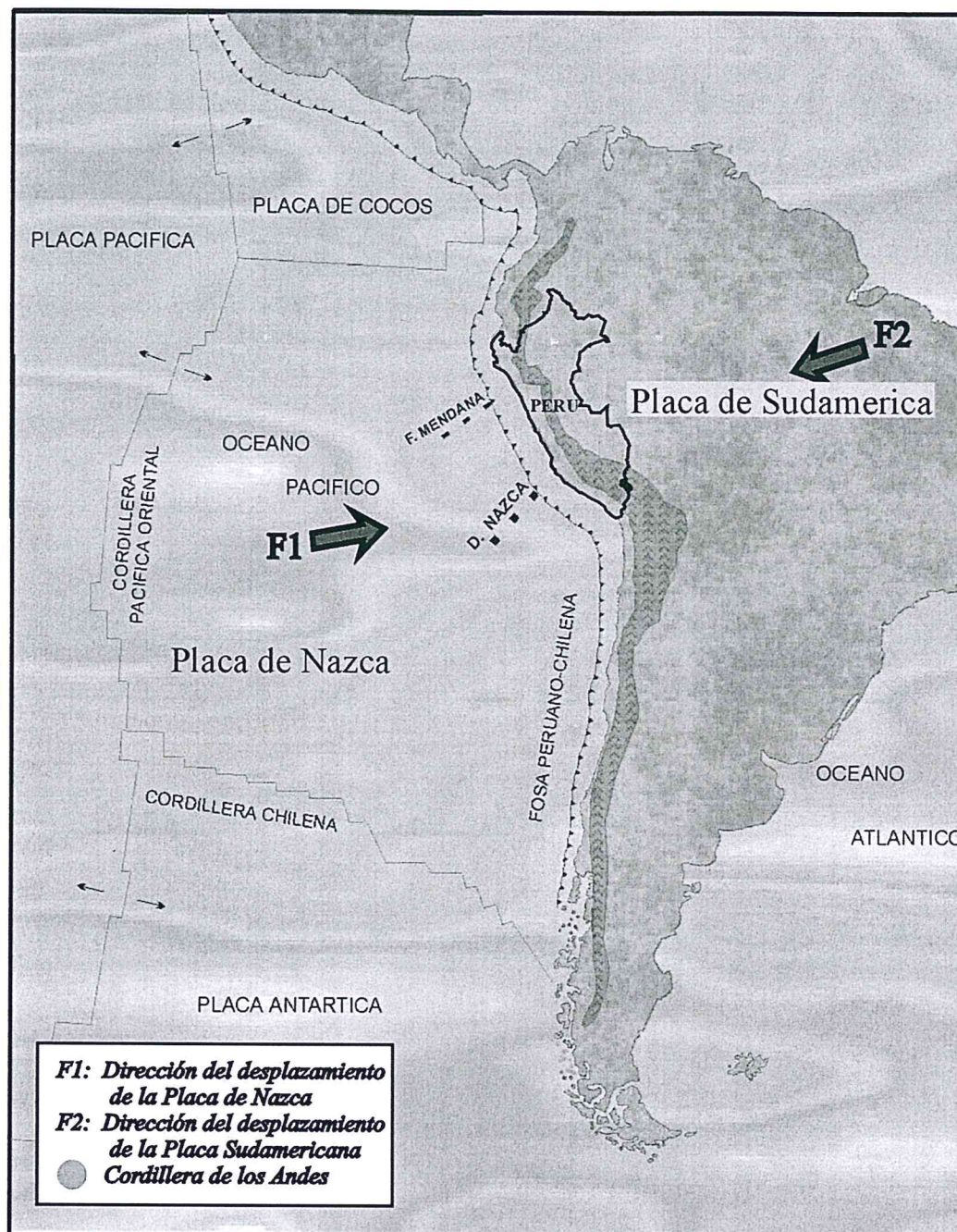
Figura 11. Esquema del proceso de convergencia de la placa de Nazca (oceánica) y la placa sudamericana (continental). Además se observa la fosa peruano-chilena en líneas rojas (Fuente Bernal y Tavera, 2002)
